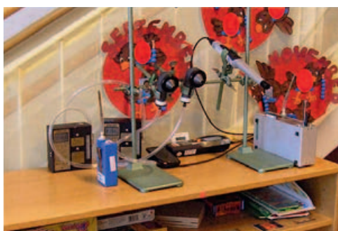
Messeinrichtung zur Probenahme von Phthalaten in Kindertagesstätten
