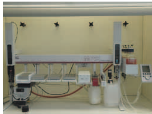
Multi Purpose Sampler für die automatische Festphasenextraktion
