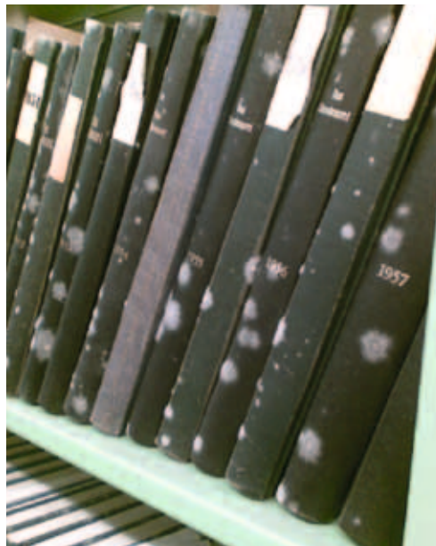
Schimmelpilzbefall auf Akten
