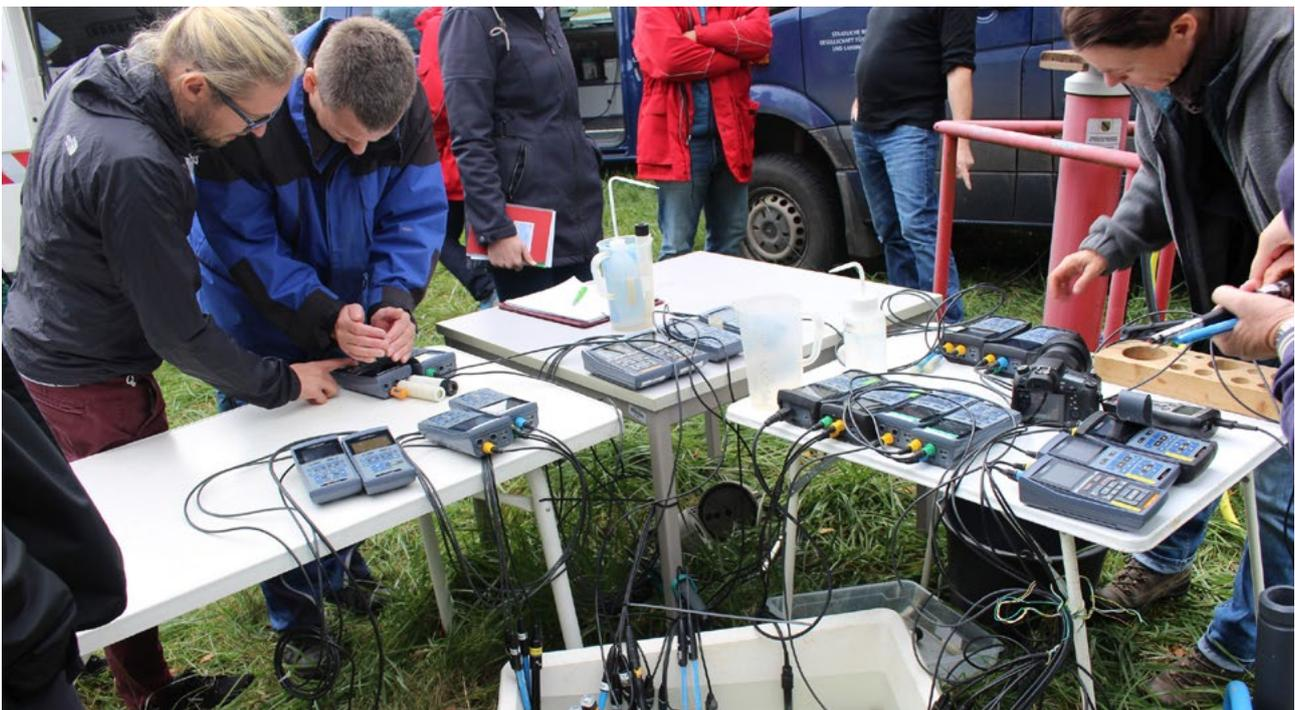
**Abb. 43:** Vergleichsmessung der bei einer Grundwasserprobenahme erhobenen Vor-Ort-Parameter in einem gemeinsamen Behälter
