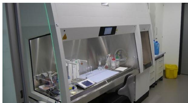
**Abb. 27:** Sicherheitswerkbank „Claire pro C-3-160“ Fa. Berner; hier finden die Einwaage von CMR-Standardsubstanzen, die Herstellung der Standardlösungen sowie die Probenaufarbeitung statt
