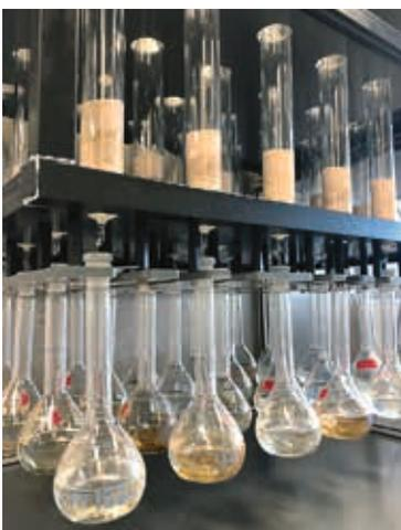
**Abb. 4.8:** Extraktionssäulen und Auffangkolben zur Bestimmung der Kationenaustauschkapazität.
