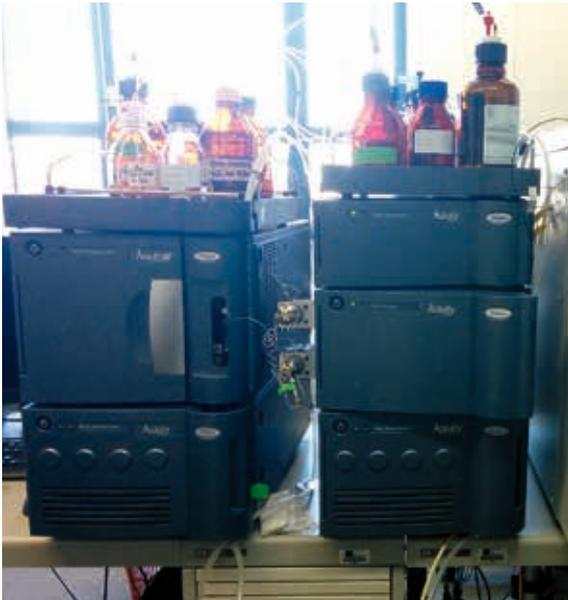
**Abb. 3.18: LC-MS/MS Quattro Premier XE der Firma Waters, zum Nachweis von Rückständen an Warfarin-Derivaten**
