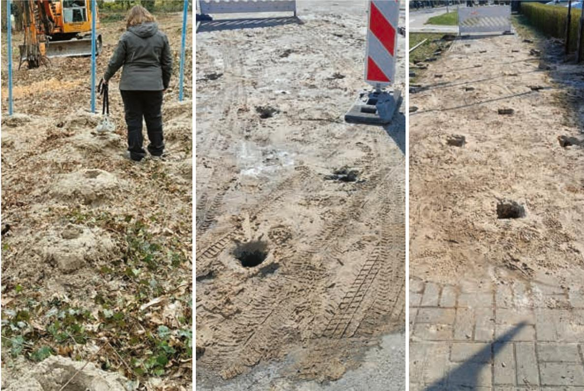
**Abb. 4.14: Beispiele für Bohrlöcher mit Bohrgut (Bohrlochsondierung mit Bohrguthaufen, Spülbohrung in der Straße und Spülbohrung im Fußweg ohne Bohrguthaufen)**
