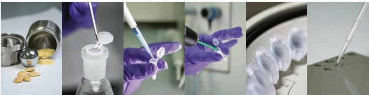
**Abb. 1.8:** Darstellung der Probenaufarbeitung für die MALDI-ToF-MS-Analyse (Homogenisierung, Einwaage, Extraktion und Applikation)
