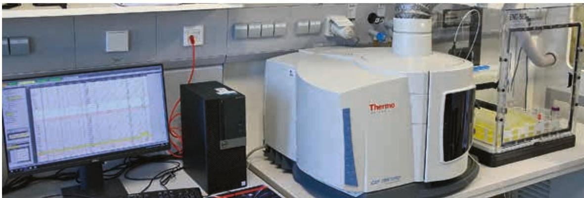
**Abb. 4.2: Metalle in Böden und Schwebstoffen werden mittels induktiv gekoppelter Plasma-Emissionsspektroskopie (ICP) in einer Königswasser-Extraktionslösung analysiert**
