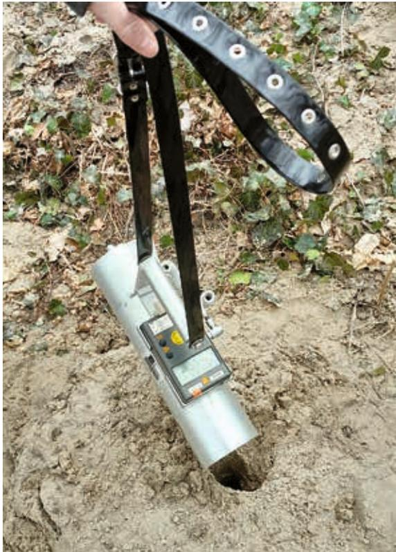
**Abb. 4.13: Sonde 6150AD-b/E mit Anzeigegerät 6150AD6/E bei Messung an einem Bohrloch**
