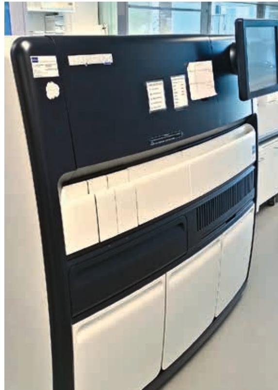
**Abb. 3.6: Automatischer Immunoassay-Analysator LIAISON XL**
