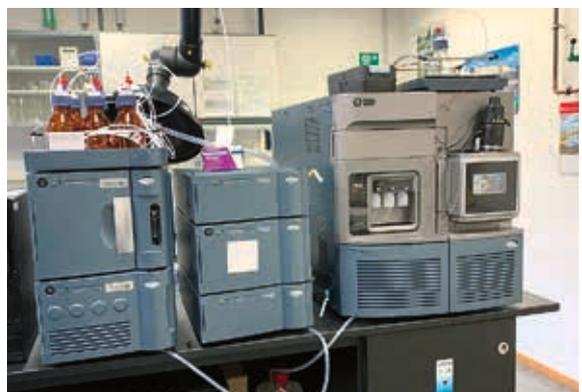
**Abb. 4.10:** Für die Untersuchung der Per- und Polyfluoralkylsubstanzen (PFAS) steht das LC-MS/MS-System „ACQUITY UPLC H-Class“-System, gekoppelt an ein „Xevo TQ-XS“-Massenspektrometer von Waters, zur Verfügung
