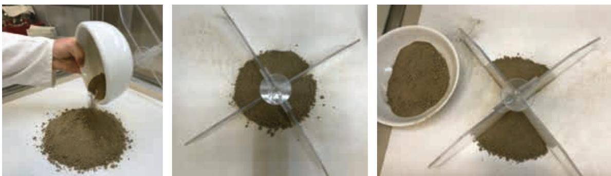
Abb. 4.4: Beispiel für das Teilen von Bodenproben durch Kegeln und Vierteln mittels Teilungskreuz
