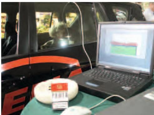
Simulation einer alltäglichen Situation im Straßenverkehr: Versuchsaufbau: Feinstaubmessung während des Zigarettenkonsums im Fahrzeuginnenen – Aerosolspektrometer in Kopfhöhe eine Puppe auf dem Rücksitz
