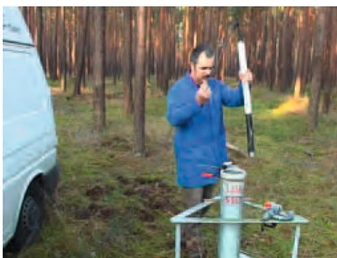
Probenahme an einem Grundwasser-Pegel
